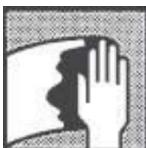
Poškozené místo zcela zbavit rzi, povrch důkladně vybrousit a vyčistit silikonovým odstraňovačem obch.č. 680 090. Poškozené místo musí být odmaštěné, zbavené prachu a suché.
