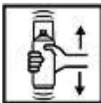
Před použitím důkladně protřepejte po dobu min.2 minut až do slyšitelného nárazu kuliček. Zkuste zkušební nástřik.
